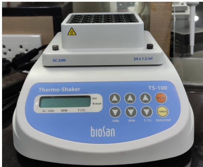
รูปที่ 1 แสดงลักษณะของเครื่องเขย่าและให้ความร้อนแก่หลอดทดลอง (Thermo shaker) รุ่น biosan TS-100
