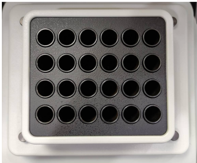
รูปที่ 3 แสดงส่วนบรรจุหลอดบรรจุตัวอย่างของเครื่องเขย่าและให้ความร้อนแก่หลอดทดลอง รุ่น biosan TS-100
